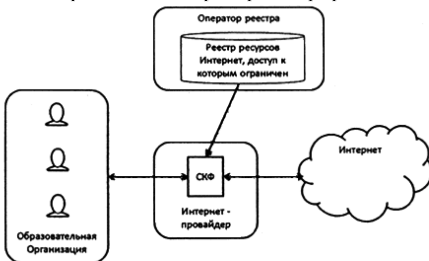
Рис.4. Схема работы контент-фильтрации при размещении у интернет-провайдера
