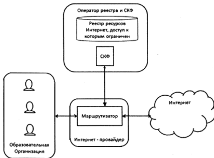
Рис.5. Схема работы контент-фильтрации при едином решении
